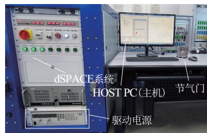
图 2 ET系统实验平台
